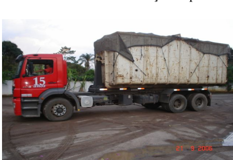
FOTO 5: Caçamba engatada ao caminhão Fonte: Arquivo da empresa.
