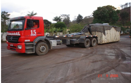
FOTO 3: Levantamento da caçamba pelo sistema roll-on, roll-off . FOTO 4: Engate da caçamba ao caminhão
