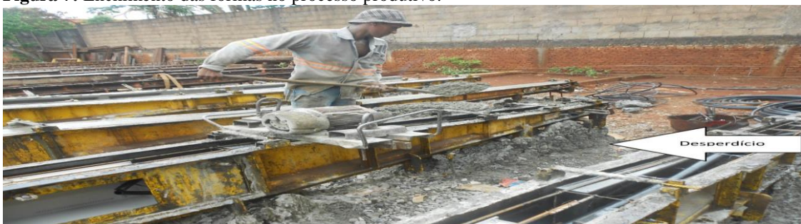
Figura 7: Enchimento das formas no processo produtivo.
