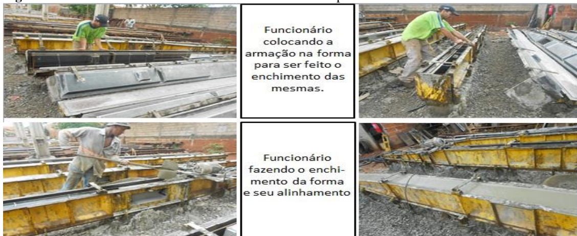
Figura 5: Processo de enchimento e alinhamento da matéria prima.
