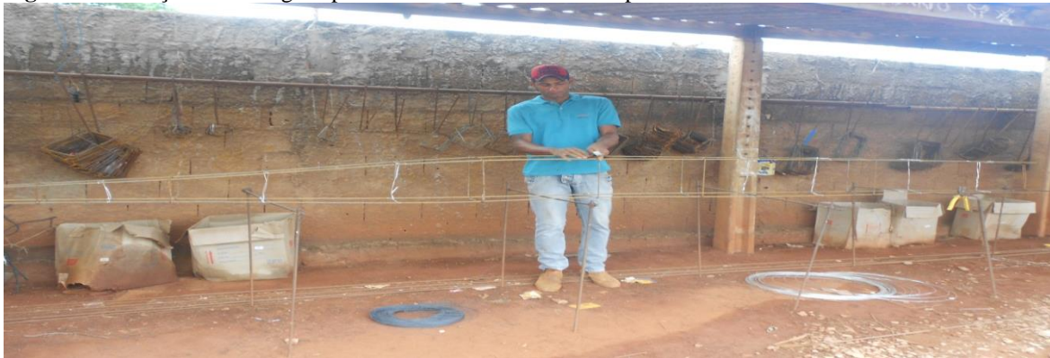
Figura 3: Armação das ferragens para determinar a estrutura do produto.
