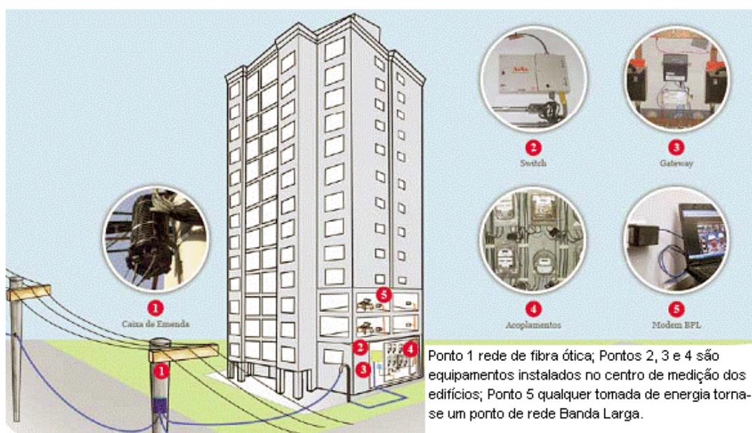
Figura 3: Solução adotada pela AES Eletropaulo Telecom
